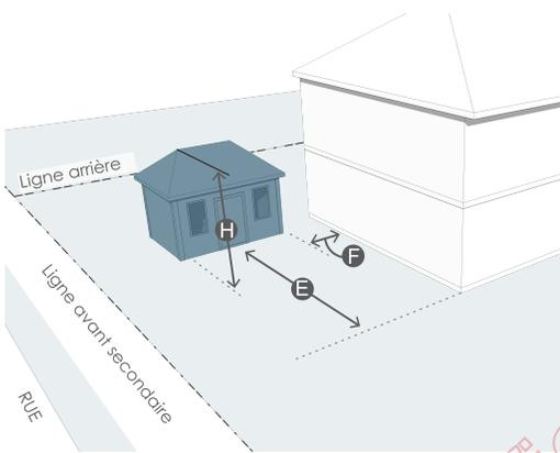
Figure 55. Distance minimale du bâtiment principal, retrait minimal par rapport au plan principal de la façade principale avant et hauteur maximale d'une remise
