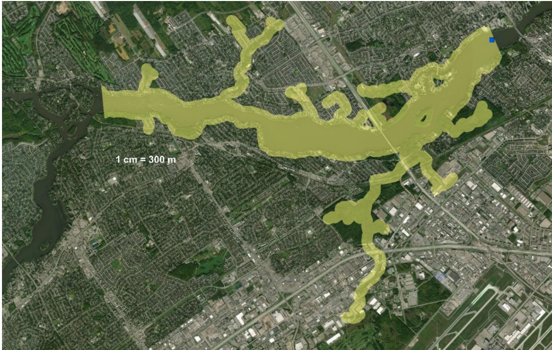
Figure 11 : Aire de protection intermédiaire (en jaune) du site de prélèvement (carré bleu) de l'UTEP Chomedey
