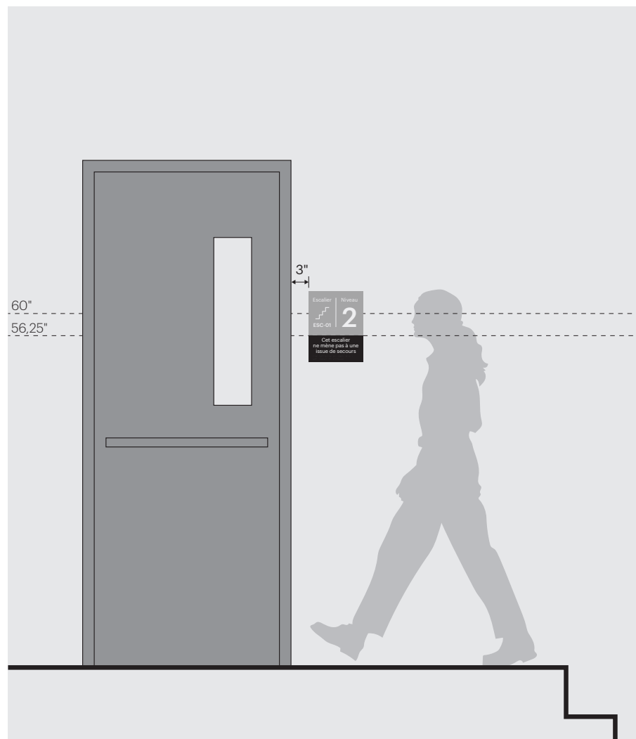
IN.1 - 9,25" x 4,5" intérieur de la cage d'escalier
