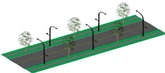
Figure 7 : Implantation en quinconce, dans un gabarit avec banquettes, avec des lampadaires combinés
