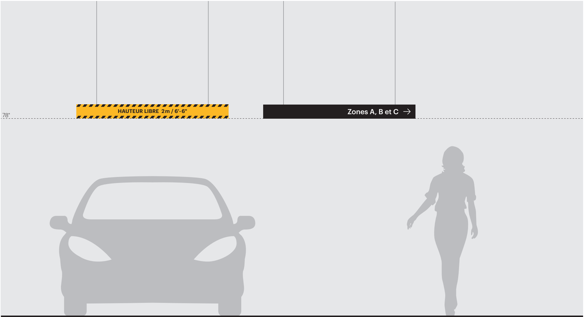
IHL Identification hauteur libre 60" x 5,5" DS.S Directionnel - suspendu - stationnement 60" x 5,5"
